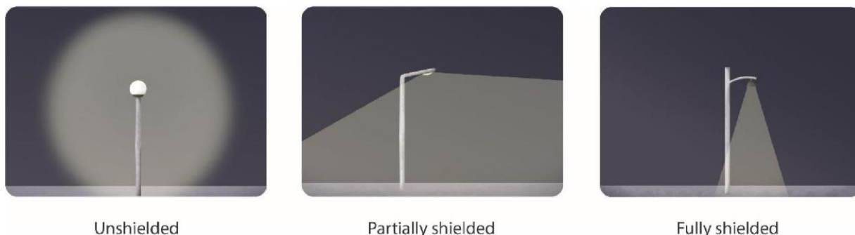
Figura 11 Las luces deberán apantallarse para evitar que se ilumine cualquier cosa que no sea el área o el objeto a que se destina la iluminación. Figura adaptada de Witherington y Martin (2003) 3 .
