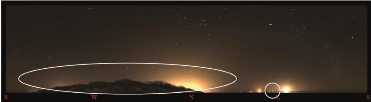
Figura 20 Resplandor del cielo creado por luces protegidas por una pantalla de vegetación (en el círculo a la izquierda) y fuentes puntuales de luz directamente visibles (en el círculo a la derecha).
