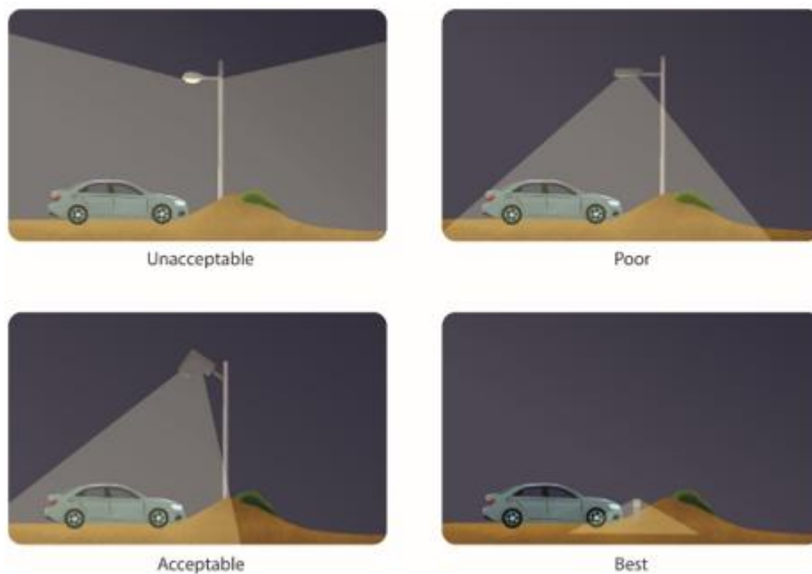
Figura 14 Opciones de iluminación para un estacionamiento. Figura adaptada de Witherington y Martin (2003) 3 .
