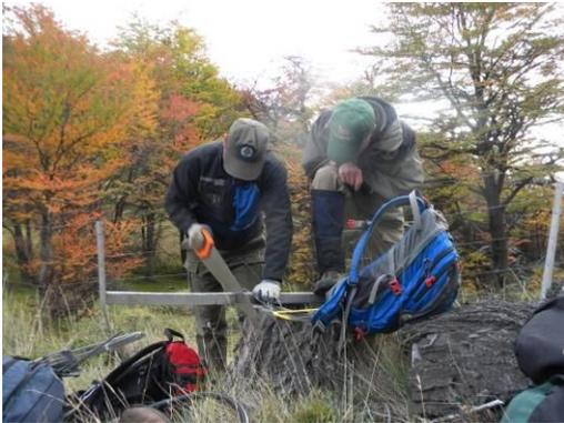
3° etapa: Corte de varillas de madera de 40 cm de largo, a las que se debe hacer una ranura en sus extremos
