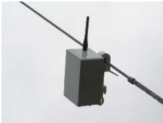
Figure 22 : Bird Strike Indicator (BSI) fixé sur une ligne électrique. Les BSI (indicateurs de touches) sont des appareils assez petits qui peuvent être fixés sur une seule ligne électrique et qui enregistrent automatiquement les collisions aviaires basées sur la vibration du câble.
