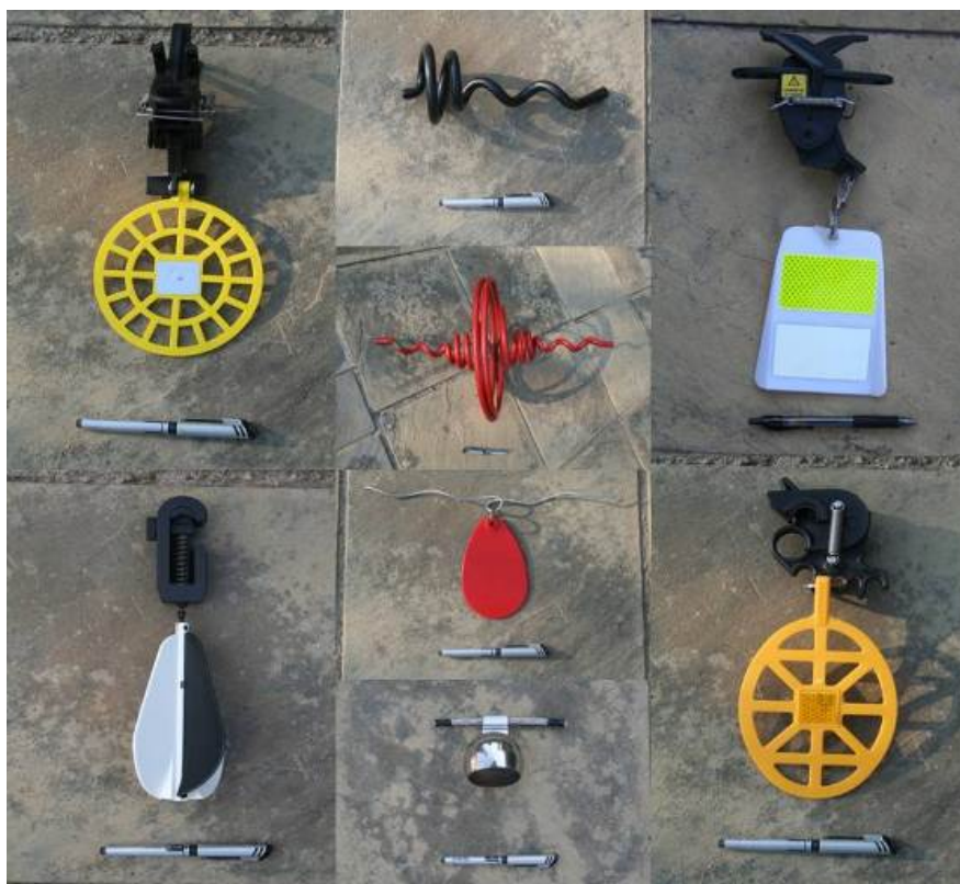
Figure 11. Dispositifs de balisage des lignes (non exhaustif) placés à intervalles réguliers sur les conducteurs et/ou les câbles de garde pour les rendre plus visibles par les oiseaux en vol. Sur chaque photo figure un stylo (d'environ 14 cm) afin de fournir une échelle (Photo: EWT-WEP).
