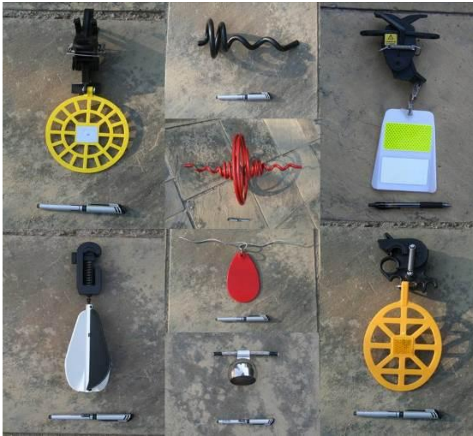
Figure 21. Différents dispositifs de marquage de lignes (non exclusif). Un stylo d'environ 14 cm de long figure dans chaque photo pour donner une idée de la taille (Photo : EWT-WEF).
